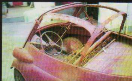
2. Anos a céu aberto comprometeram a estrutura da parte superior da carroceria
