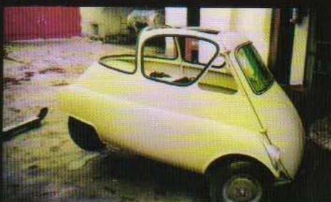
4. Funilaria pronta, a carroceria com primer, ajuste dos pára-choques, faróis e vidros
