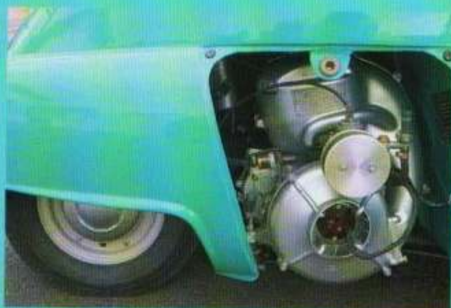
O acesso ao motor de 236 cm 3 é feito por uma portinhola na lateral
