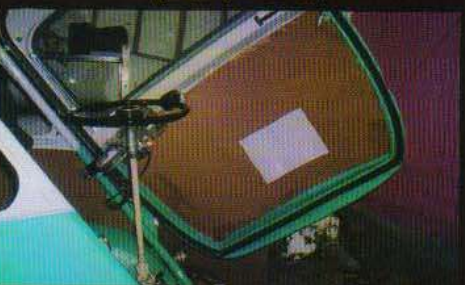
10. Moldagem da tapeçaria com chapas de eucatex encaixadas na porta e laterais internas
