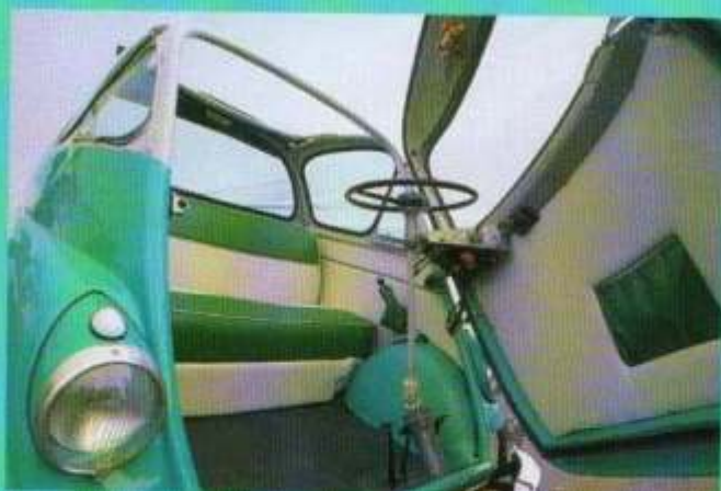
A coluna de direção acompanha o movimento da porta
